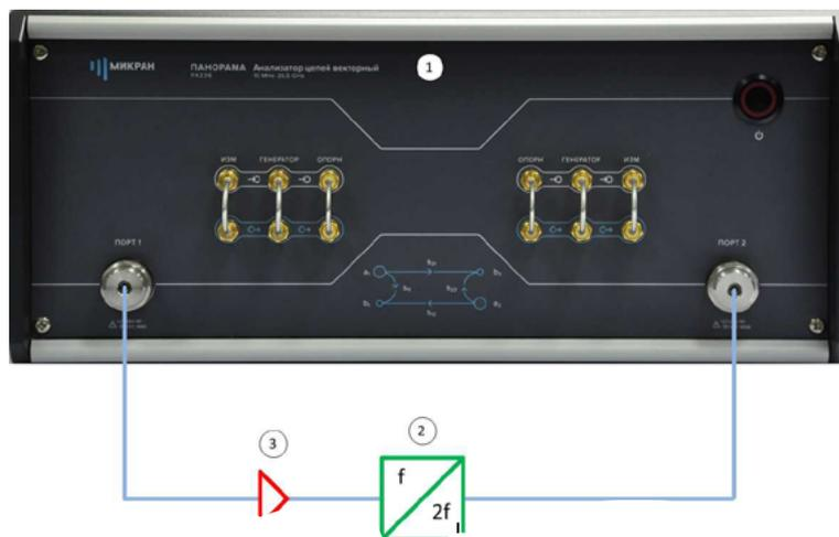
Рис. 9. Измерение с усилением зондирующего сигнала без опции «ДПА»:
